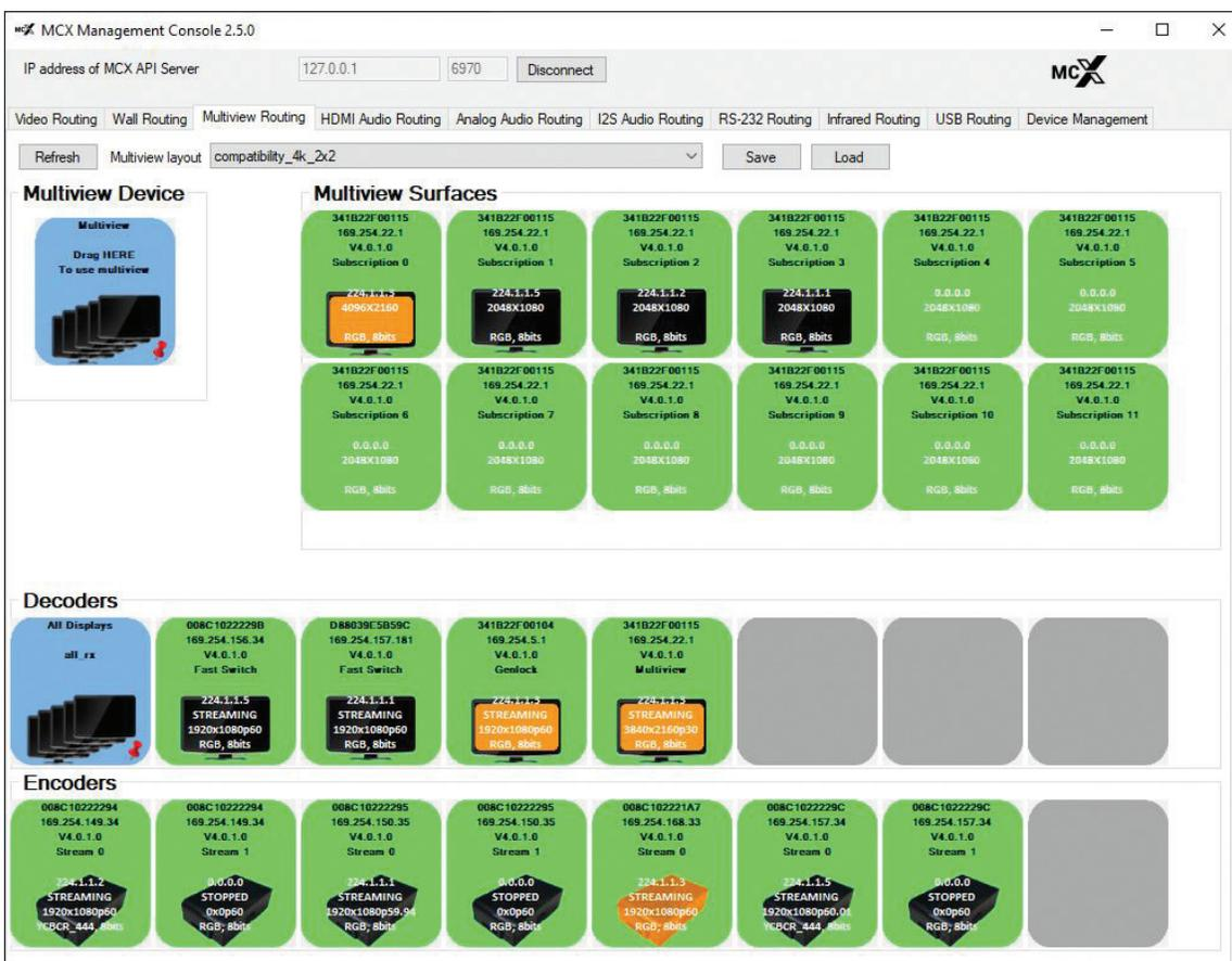
FIGURE 4-14. EXAMPLE USING COMPATIBILITY\_4K\_2X2 LAYOUT
