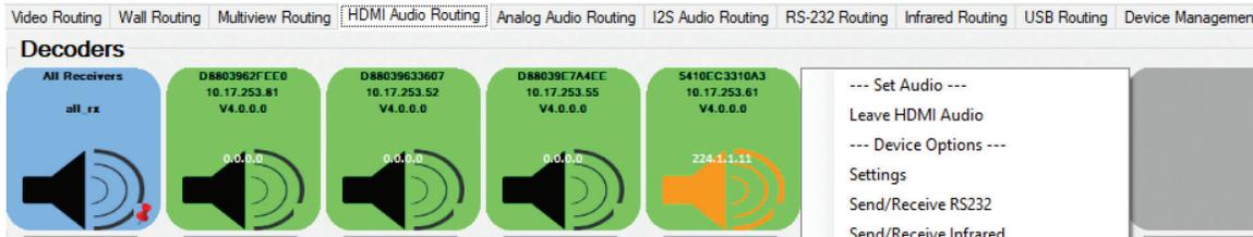
FIGURE 4-21. DECODER (RX) HDMI AUDIO TAB – LEAVE OPTION
