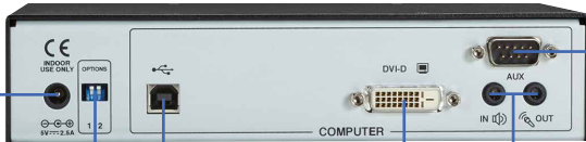
INGRESSO DI ALIMENTAZIONE OPZIONI SWITCH PORTA USB DI TIPO B VIDEO DVI-D LINEA AUDIO IN/OUT SERIALE DB9 PORTA
