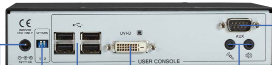
INGRESSO DI ALIMENTAZIONE OPZIONI SWITCH PORTE USB DI TIPO A VIDEO DVI-D LINEA AUDIO IN/OUT SERIALE DB9 PORTA
