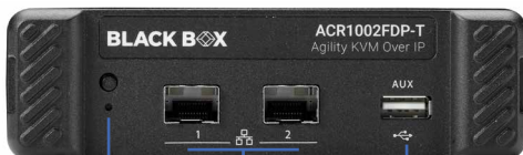
INTERRUTTORE DI RESET E INDICATORE DI STATO CATX E COLLEGAMENTO SFP PORTE PORTA AUSIL. USB (DA UTILIZZARSI CON CONVERTITORI DA USB A SERIALE)
